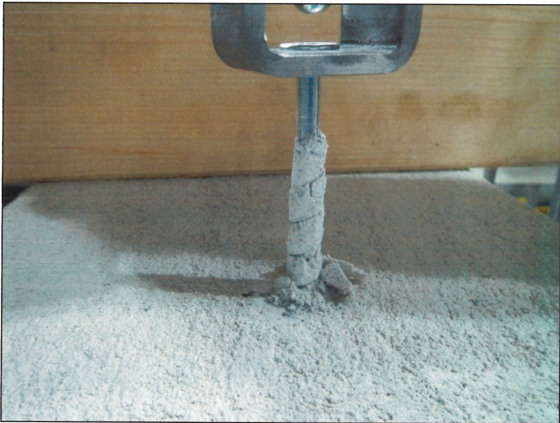
Abb. 18 Ausgerissene Schraube der Prüfserie 2
