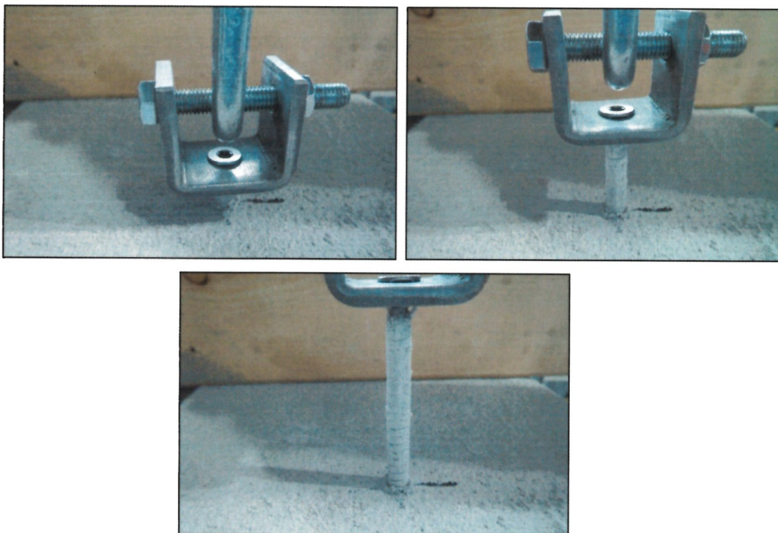
Abb. 37 bis 39 Versagensart der Prüfserie 5
