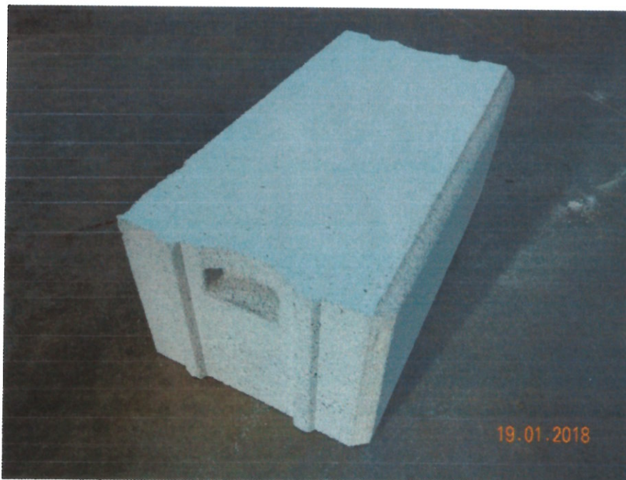
Abb. 1 Verputzter YTONG Thermobloc 08 - 30 x 25 x 60 cm
