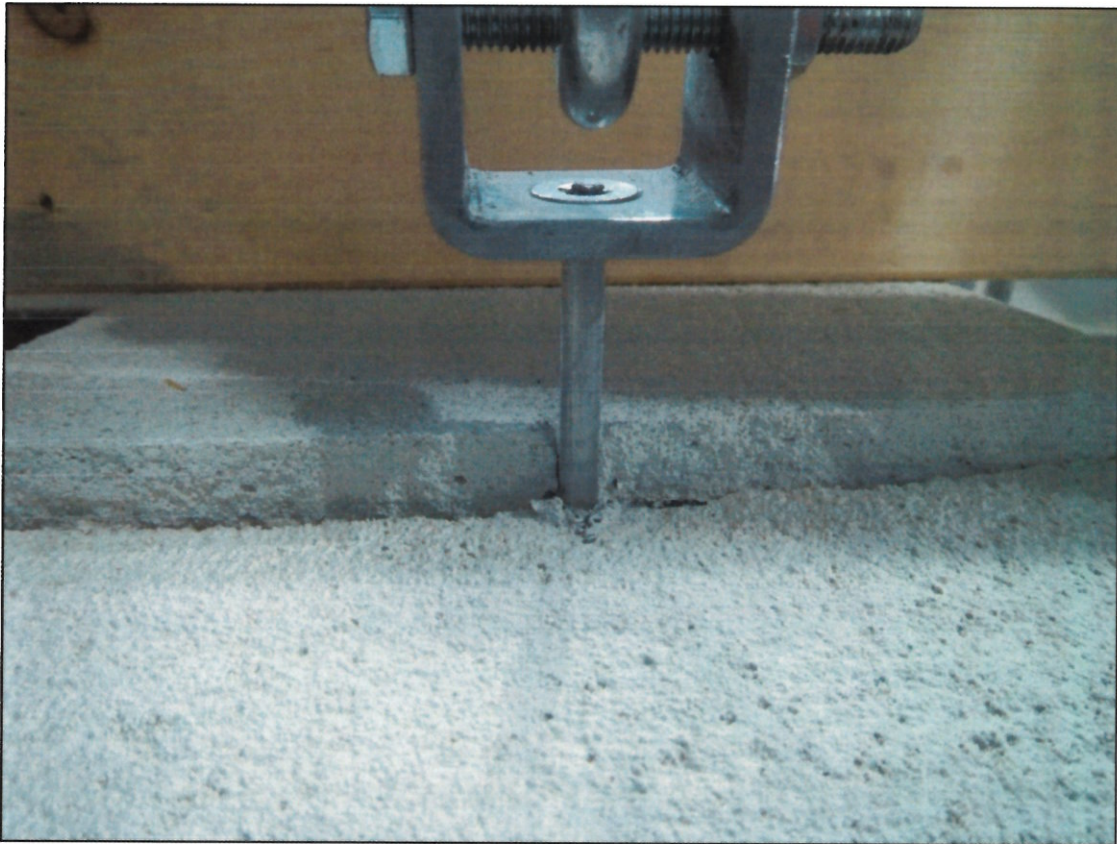
Abb. 13 Ausgerissene Schraube der Prüferserie 1
