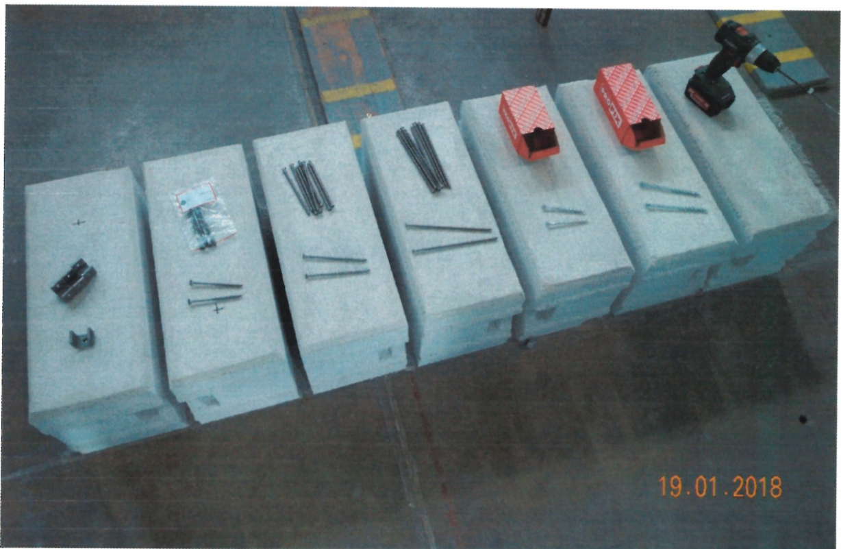
Abb. 4 YTONG Thermobloc 08 mit Putz, bereit für die Auszugsversuche.
