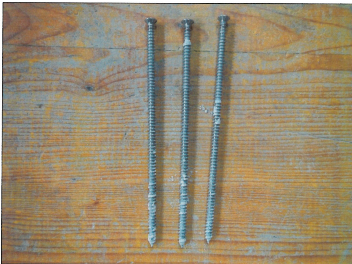
Abb. 40 Schrauben der Prüfsreihe 5 nach dem Test
